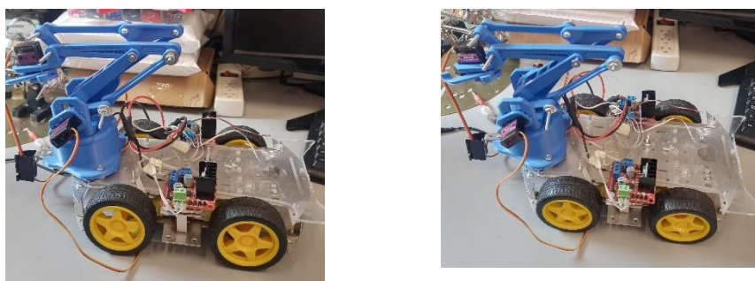
Figura 1. Prototipo de sistema móvil autónomo con manipulador integrado
