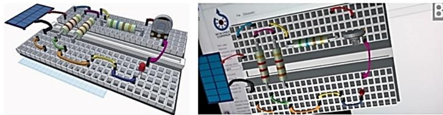
Figura 5. Diagrama 3D de conexión mixto de resistencias (izquierda), representación del modelo 3D en la aplicación de realidad aumentada al enfocar el marcador de realidad aumentada (derecha).
