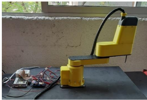
Figura 1. Robot de tipo SCARA utilizado en el proyecto
