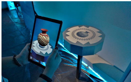
Fig. 2. Demostración de la detección y procesamiento de elementos gráficos desde la aplicación de realidad aumentada. El modelo 3D que presenta el dispositivo es una representación de una olla de arcilla perteneciente a la cultura Chupícuario.
