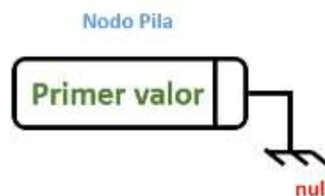
Figura 19 Creación del primer elemento de la Pila.
