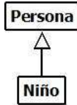
Figura 4 Diagrama UML herencia entre clases.
