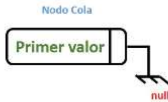
Figura 24 Creación del primer elemento de la cola.
