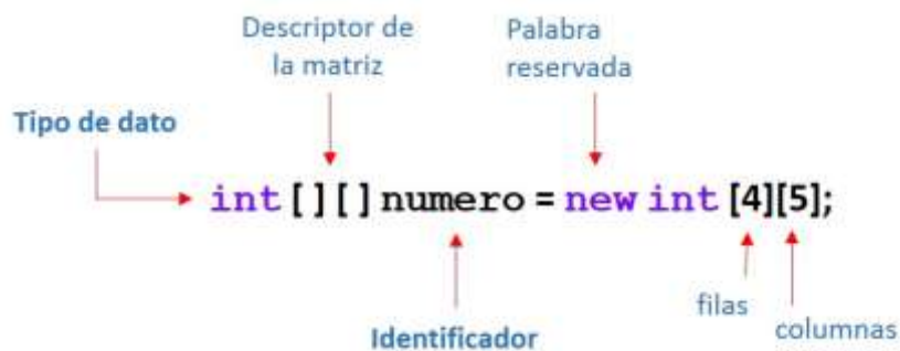
Figura 15 Estructura de un arreglo bidireccional.
